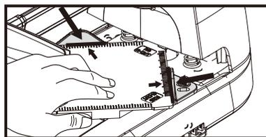
5. 2枚の用紙ガイドを調整用ゲージにしっかりと押し付けます。
