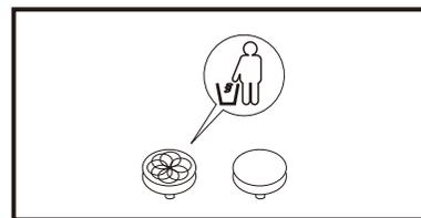
1. カッターディスクの破損が激しい場合は交換してください。
