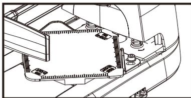
4. 調整用ゲージを作業台の上に置き、カッターにしっかりと押し当てます。コーナーが選択したカッターと対応していることを確認してください。
