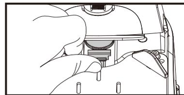
4. ディスクを取り付けたマウントを所定の位置にセットします。
