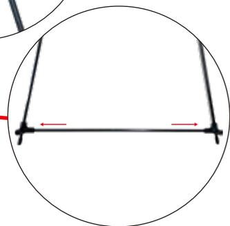
**1** ハングサイン支柱を図のように差し込み口が上向いている方にベースフレーム (短) を差し込みます
