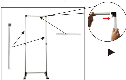
4. 上部縦バー(A)と上段横バー(C)の溝部分が本体の内側になるように、図のように組み立ててください
