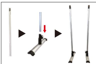
2. 下段縦バー(B)の溝部分が内側になるように、ブラケットの差し込み口に差し込んでください。
